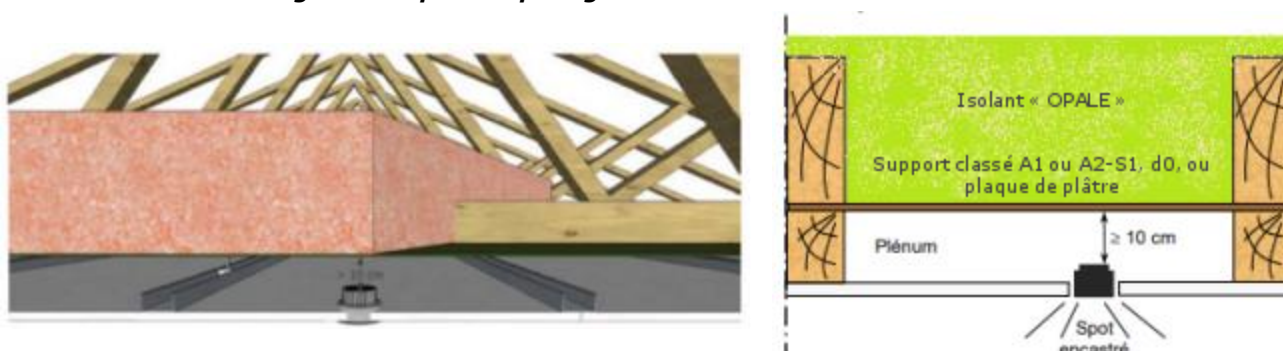
Figure 2 – Spot encastré dans un plénum (hors ERP)
