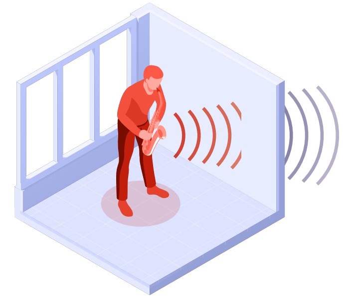
Filtrage des bruits : Des sons agréables à l'écoute directe peuvent devenir insupportables une fois filtrés à travers un mur (filtrage de certaines fréquences)
